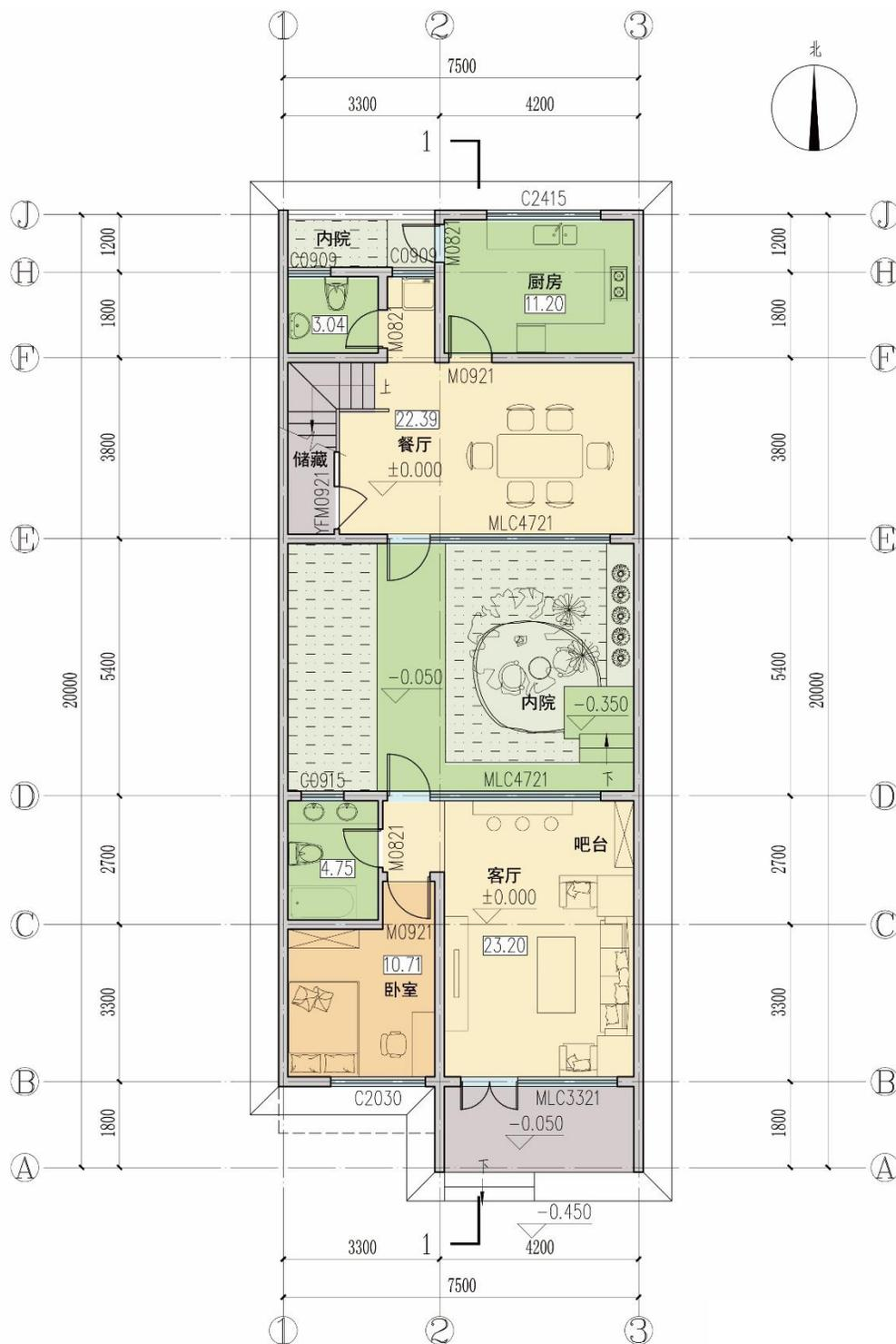
一层平面图 本层建筑面积：149.60m<sup>2</sup>
