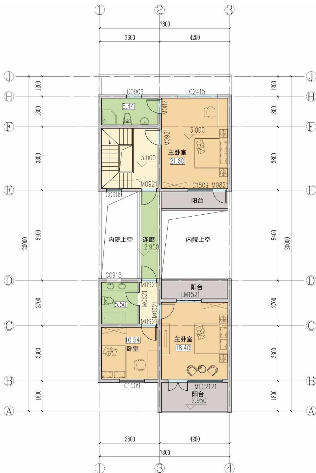
二层平面图 本层建筑面积99.21m<sup>2</sup>
