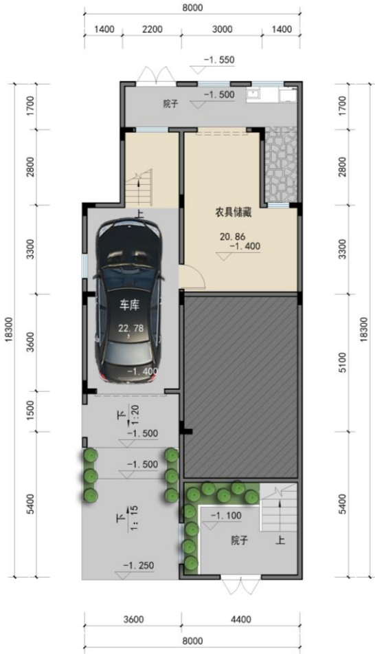
车库层平面图 本层建筑面积59.46m 2
